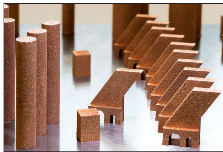
▲ 99,8 % Dichte und eine Leitfähigkeit von ca. 95 % IACS erreicht Heraeus in der additiven Fertigung von hochleitfähigen Kupferbauteilen mit Standard-Pulverbett-Laserschmelzanlagen.
