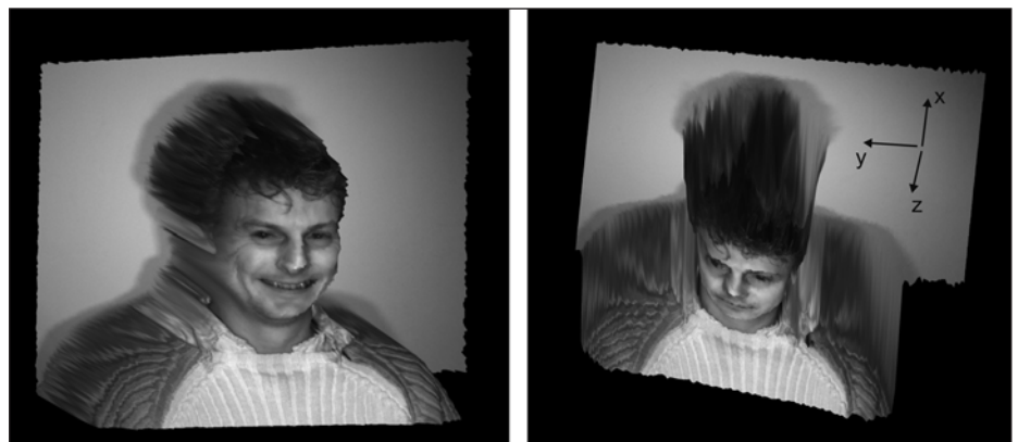
▲ Abb. 3: Überlagerung eines 2D-Grauwertbildes mit einem 3D-Tiefenbild
