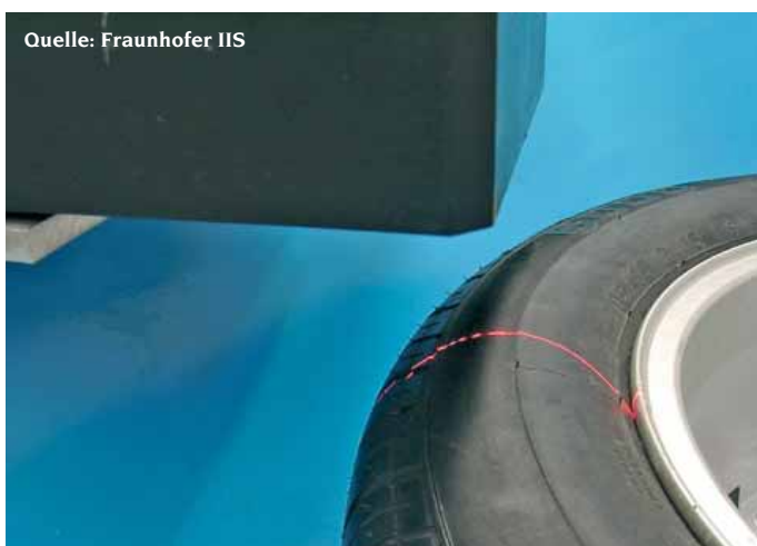
▲ Abb. 1: Mittels Lichtschnittverfahren vermessener Reifen
