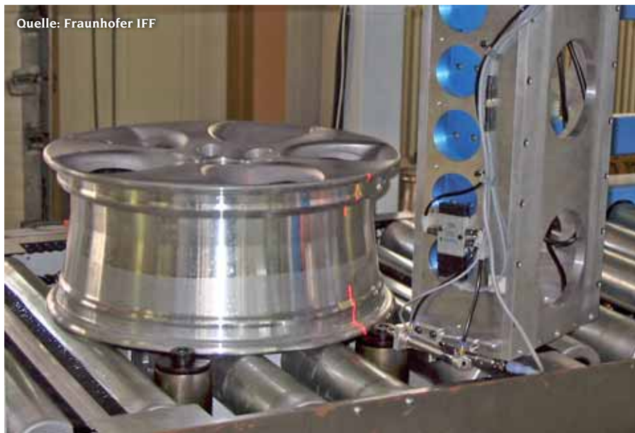
▲ Abb. 3: Fertigungsintegrierte Geometriemessung von Kfz-Rädern
