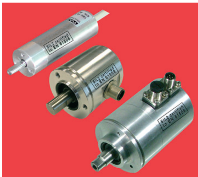
▲ Monotour- und Multitour Winkelcodierer mit 25, 50 und 65 mm Gehäusedurchmesser und redundanter CANopen-Safety-Sensorik.
