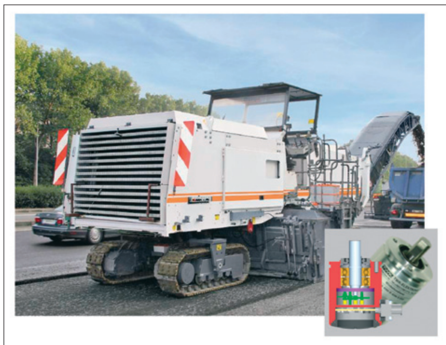
▲ Elektromagnetische Winkelcodierer zur Lenkung von Straßenfräsen und zur Schwenkung des Förderbandes bei der Abraumentsorgung. Bild: Wirtgen Group / TWK
