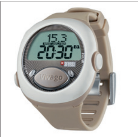
▲ Das Vivago Wristcare-System für Senioren meldet z. B. mithilfe von Temperatur- und Bewegungssensoren, wenn irgendetwas 'nicht stimmt' Quelle: Vivago Oy®
