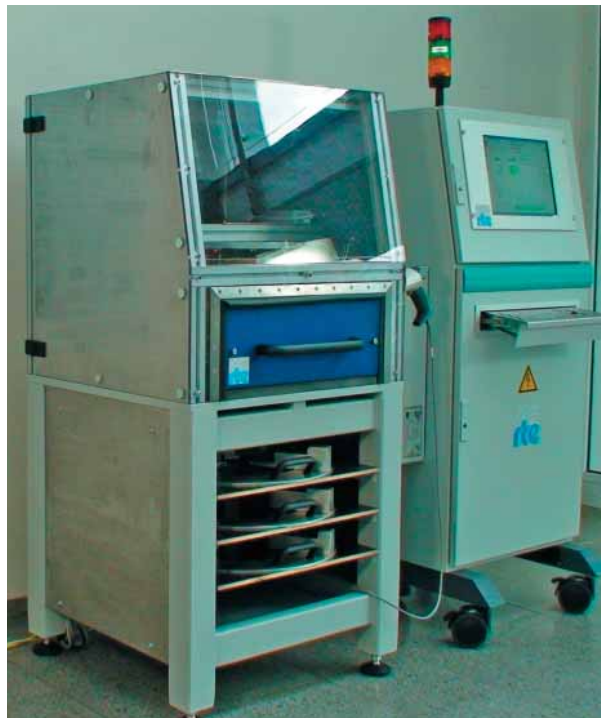
▲ Handprüfplatz zur Risserkennung an Brems scheiben
