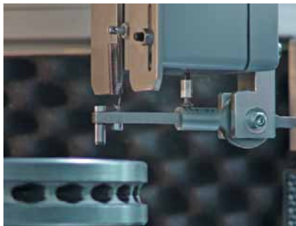
▲ Brems scheibe im Prüfnest mit Anregklöppel
