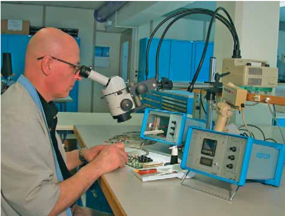
▲ Höchste Präzision und Konzentration sind nötig für die Endmontage des optoelektronischen Sensor-Moduls und der Lichtleitersonde in den Produktionsräumen der Sensoptic AG. Angesichts der Miniaturisierung ist dies nur unter dem Mikroskop möglich.
