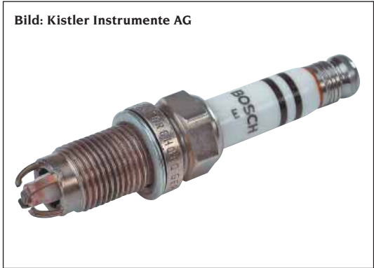
▲ Optisches Fenster in der Mittelelektrode einer Serienzündkerze
