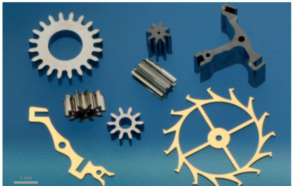
▲ Mikromechanische Präzisionsbauteile nach dem LIGA-Verfahren. Anker und Ankerrad für mechanische Uhrwerke sind aus 99% Gold, die in Nickel-Cobalt hergestellten Zahnräder und Bauelemente erlauben mit Bauteilhöhen bis 2 mm eine optimale Kraftübertragung ohne Schmierung.
