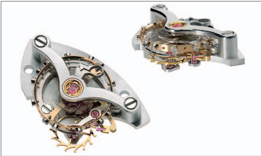
▲ Aus dem Innenleben eines mechanischen Uhrwerks: Auswechselbare Hemmungsbau- gruppe mit Anker und Ankerrad aus Gold, die mit der neuen Technologie hochpräzise hergestellt wurden. (Quelle: H. Moser & Cie.)
