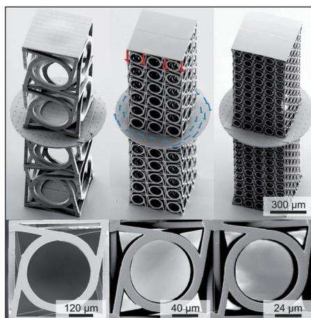
▲ Türme aus bis zu 500 chiralen Würfelstrukturen rotierten bei Belastung um die eigene Achse. Achirale Strukturen zeigen diese Eigenschaft nicht.
