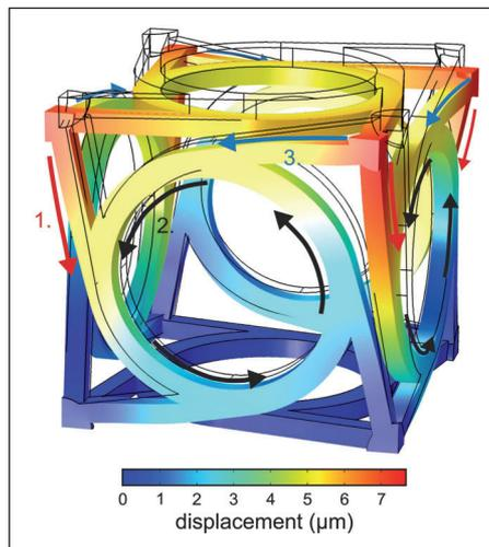
▲ Kräfte von oben werden über Stege auf die senkrecht stehenden Ringstrukturen übertragen. Deren Rotation zieht an den Ecken der waagerechten Flächen des Würfels.
