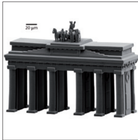
▲ Abb. 5b: Einsatzbereiche für das dreidimensionale 'Laserschreiben' finden sich u. a. auch im Rapid-Prototyping von Mikrostrukturen: Brandenburger Tor. Bild: Nanoscribe
