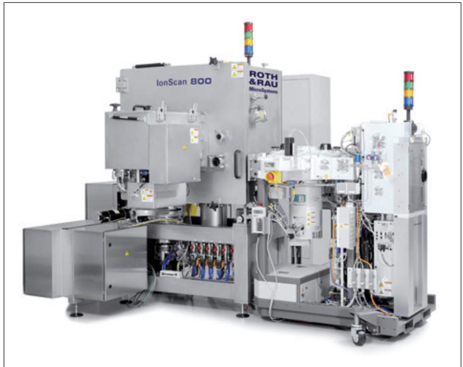
▲ Abb. 4: IonScan 800 – zur industriellen Schichtdicken- und Frequenzkorrektur
