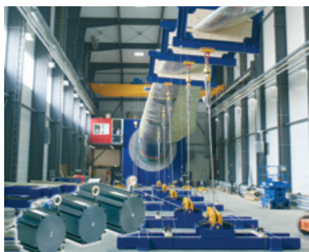
▲ Prüfstand für Rotorblätter von WKAs
