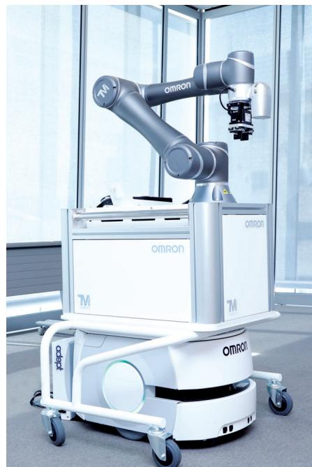
▲ Die Cobots der TM-Serie lassen sich mit den autonomen, mobilen Robotern der LD-Serie kombinieren. Das heißt, die Cobots können immer dort arbeiten, wo sie gerade gebraucht werden.
