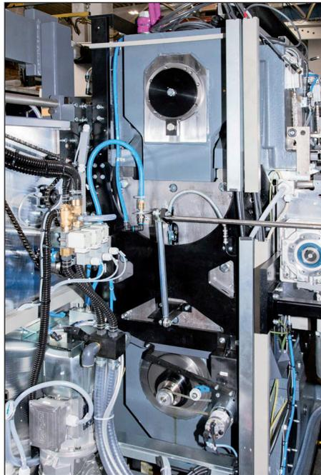
▲ Um ein »Festgehen« der Maschine zu vermeiden, überwachen Dehnungssensoren von Kistler die aufgewendete Kraft und den Prozessverlauf.
