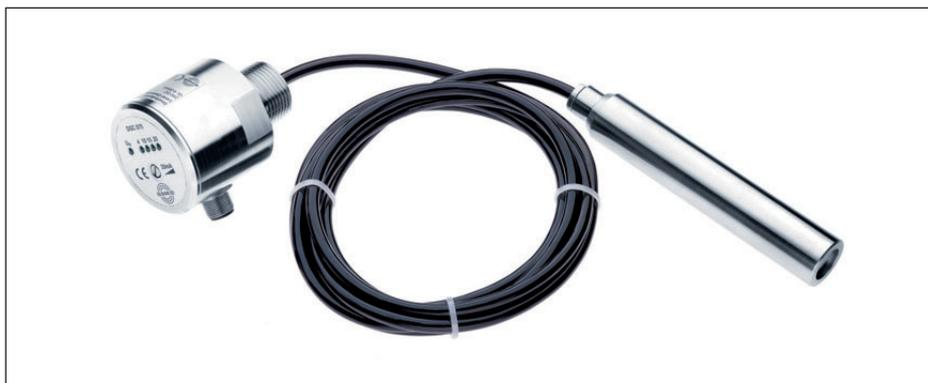
EGE bietet jetzt eine Variante seiner hydrostatischen Füllstandssensoren aus der Serie DGC an, mit der sich bei flüssigen Medien Pegel von bis zu 20 m messen lassen: Der Sensor besteht aus einem Messkopf inklusive Auswerteelektronik im robusten Edelstahlgehäuse, das sich mittels eines
