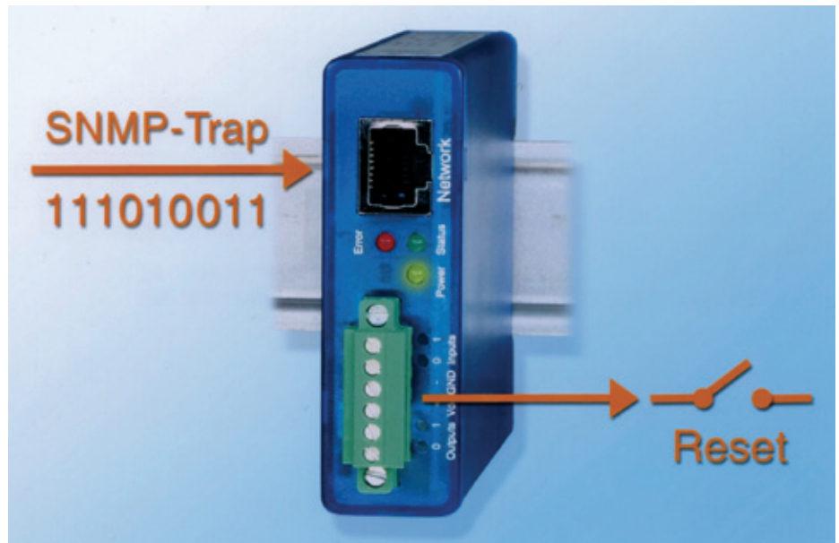
▲ Reagieren auf SNMP-Traps: Empfangene Nachricht aus dem Netz schaltet Verbraucher
